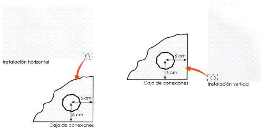
El tubo de los conductores eléctricos que va fijado dentro de las rozas es normalmente de un diámetro de 23 mm ( $\varnothing$ ) y la sección de los conductores eléctricos es de 2,5 a 6,0 mm, como se ha indicado anteriormente.
